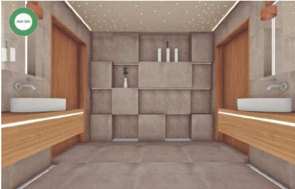
Figură 94 Așa da! Amplasarea de dozatoare de săpun și baterii cu fotocelulă reduc contactele cu zonele potențial umede, cum ar fi robinetele și săpunierele. Prosoapele de hârtie trebuie amplasate în imediata vecinătate a lavoarelor, pentru a se evita stropirea blaturilor și pardoselii.
