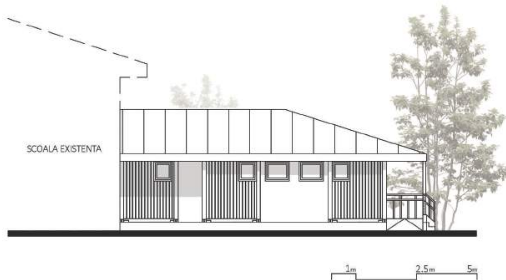
Figură 110 Grupuri sanitare realizate din containere, fațada laterală. Se observă cele trei containere transversale care generează volumul construit.
