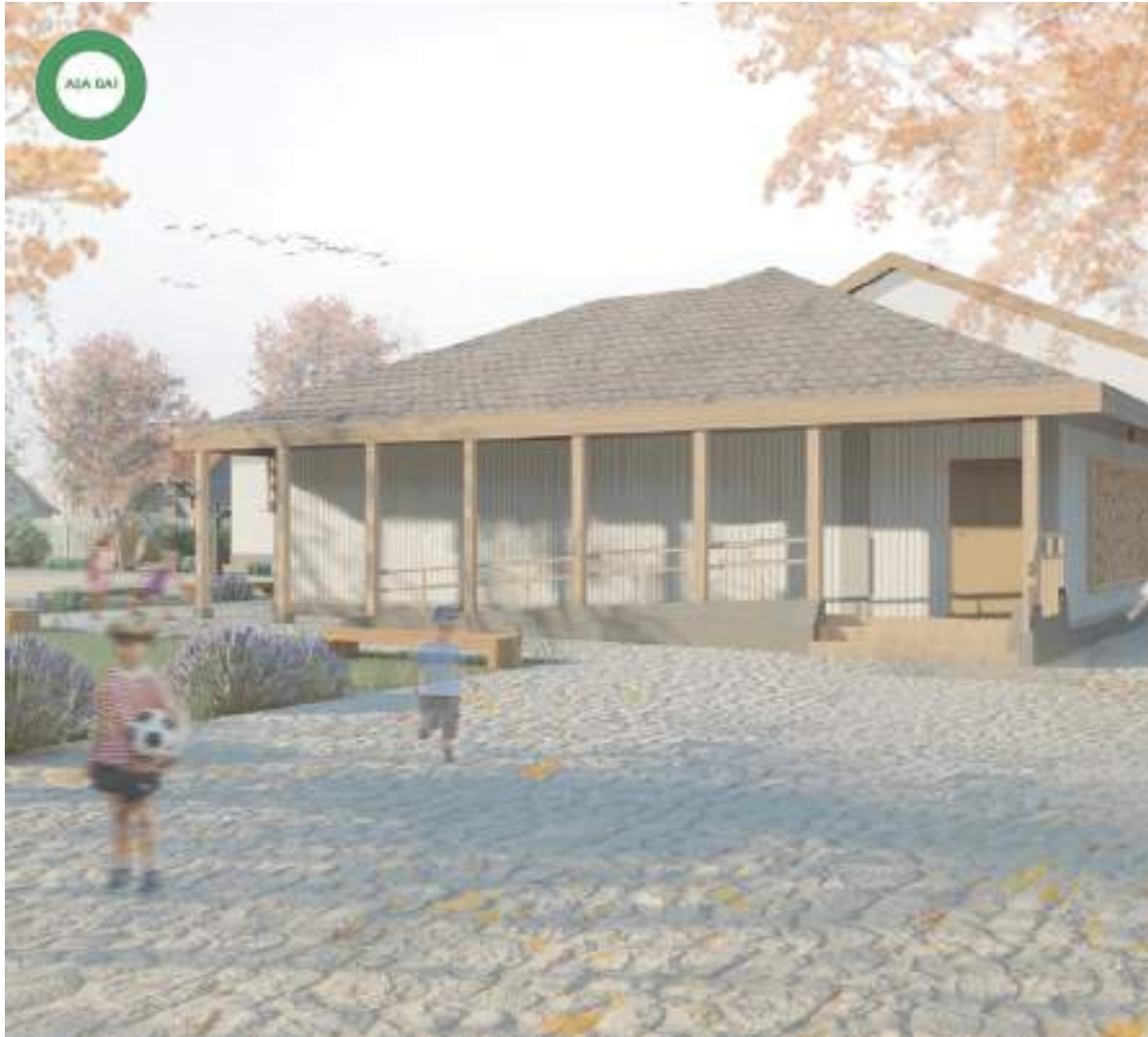
Figură 37 Rezolvare a acoperișului în trei ape. Se observă rampa de acces pentru persoanele cu dizabilități, cu panta între 5-8%, acoperită și finisată cu finisaje antialunecare.
