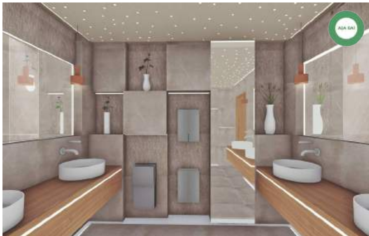
Figură 92 Așa da! Tratarea pereților cu nișe, pentru îmbunătățirea confortului acustic într-un grup sanitar.
