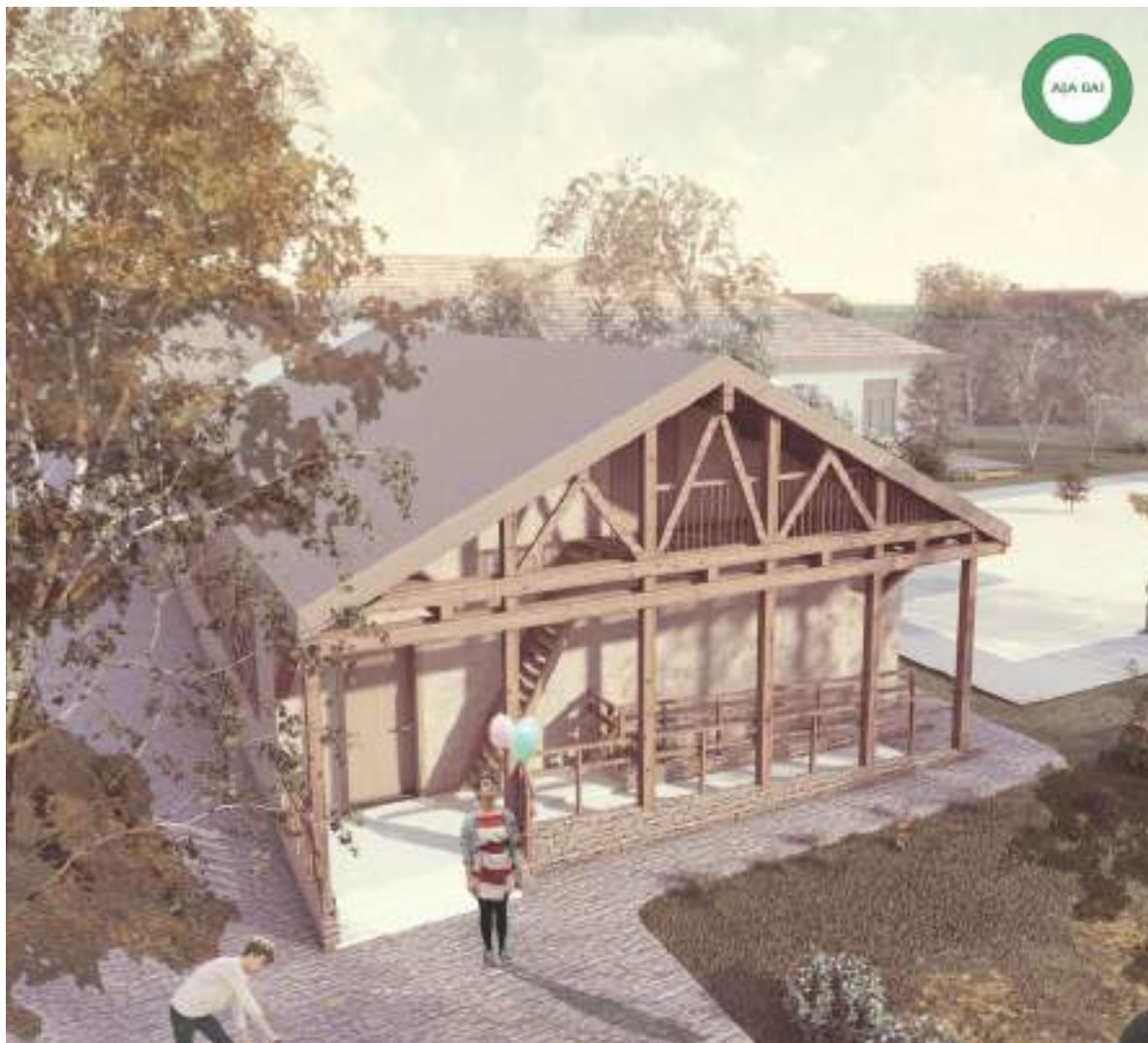
Figură 36 Așa da! Pantele acoperișurilor vor avea în vedere regimul precipitațiilor, microclimatul, orientarea față de vânturile dominante și punctele cardinale, specificul local. În imagine, rezolvarea acoperișului în două ape și timpan.
