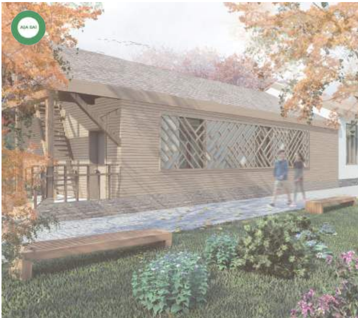
Figură 57 Așa da! Plasarea unui trafor în fața ferestrelor, cu rol de protecție, asigură o bună funcționare a ferestrelor grupurilor sanitare. Acestea trebuie să aibă gabarite mari, ce permit buna ventilare, precum și pătrunderea luminii naturale la interior, împreună cu toate efectele benefice ale acesteia.
