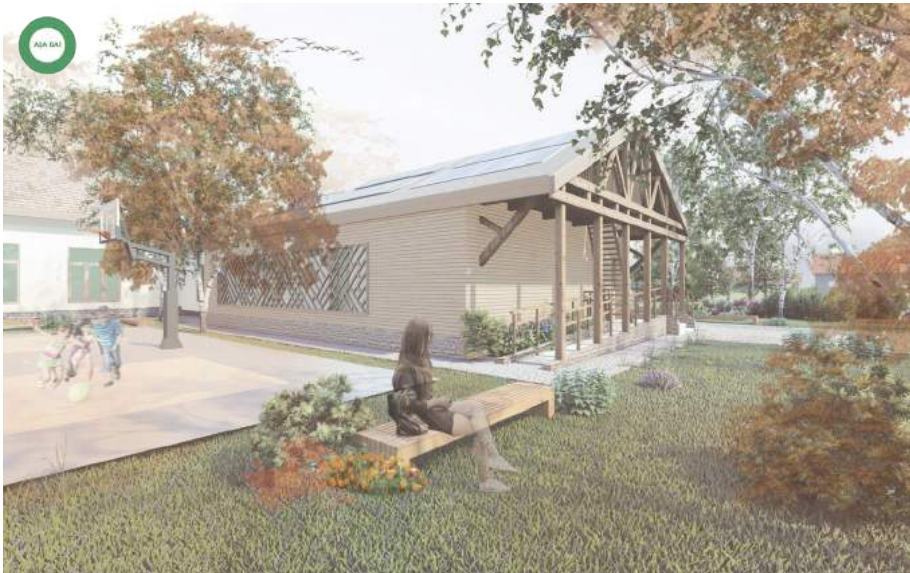
Figură 32 Extindere a școlii cu grupuri sanitare interioare, rezolvare a anvelopantei cu materiale locale și montarea de panouri solare pe învelitoare, în vederea realizării de economie de energie.
