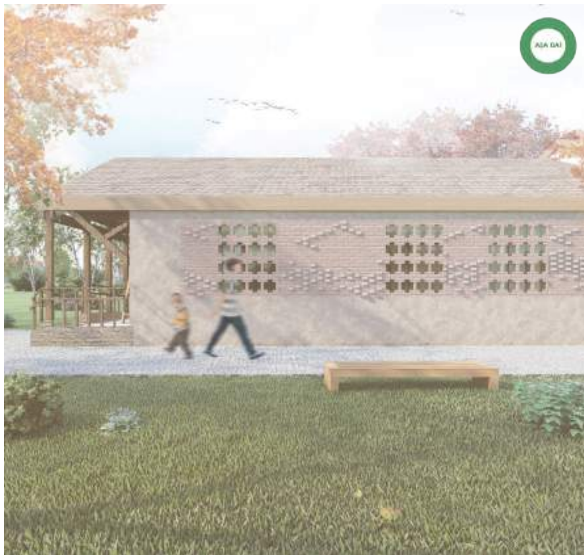
Figură 40 Așa da! Perete din pământ, sistem Adobe, rezistent și bun termoizolant, adecvat funcțiunii.
